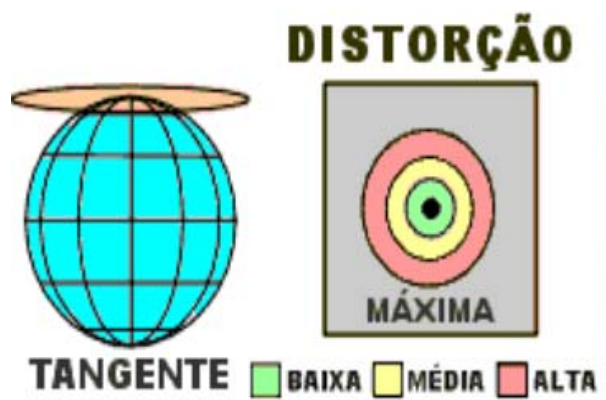
Figura 1. Representação de uma superfície esférica no plano e as distorções geradas de acordo com a distância ao ponto de tangência.
