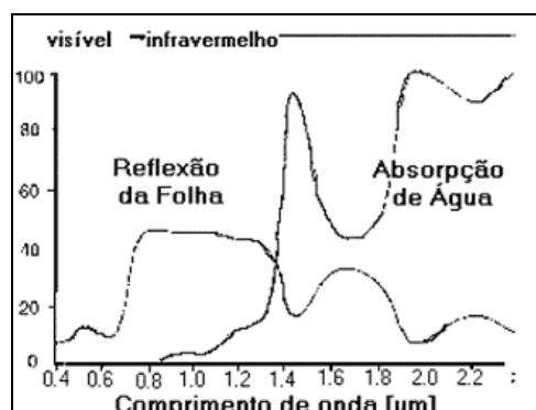
Figura 4. Refletividade espectral de uma folha verde e a capacidade de absorção de água e refletividade, absorvidade e transmissividade numa folha verde para a radiação no VIS e NIR.
